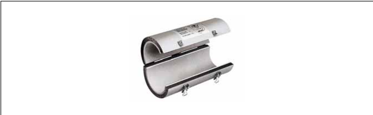
Bild 22 Brandschutz-, Körperschall- und Wärmedämm-Manschette BSM-K mit R90- Zulassung für einzeln verlegte Kunststoff-Abwasserleitungen DN 40 bis DN 150, die durch feuerbeständige Decken und Wände führen; Baulängen 300 mm; Dämmschichtdicke 9 mm (Werkbild Missel)
