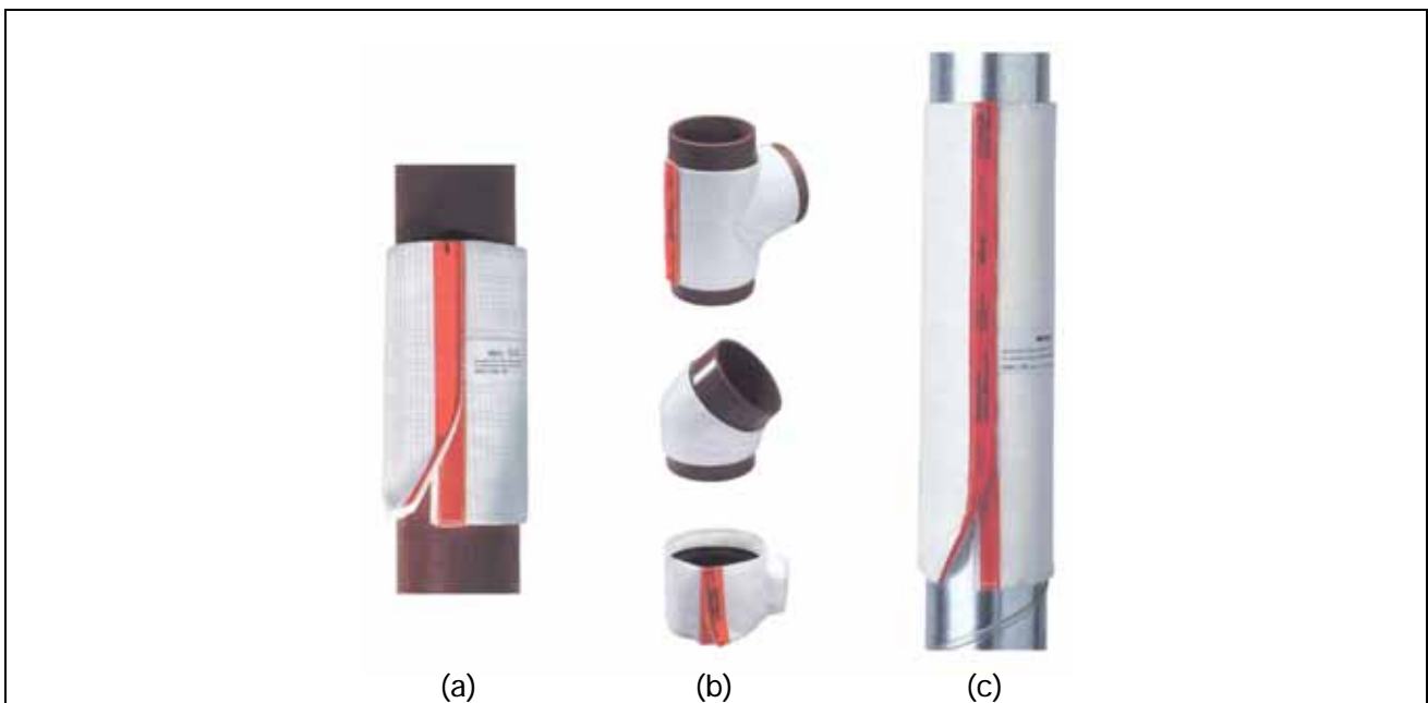
Bild 21 Die kombinierte Brandschutz- und Körperschall-Dämm-Manschette MSA 4-BSM (a) für nicht brennbare Rohrleitungen aus Gusseisen und Stahl von DN 40 bis DN 150, Baulängen 250 mm und 400 mm, gibt es auch für alle in der sanitärtechnischen Praxis vorkommenden Formstücke wie Abzweige, Bögen und Verbinder (b). Die kombinierte Brandschutz- und Körperschall-Dämm-Manschette BSM-L (c) gibt es für nicht brennbare Lüftungsleitungen bis Nennweite 200 mm, Baulänge 400. (Werkbild: Missel)
